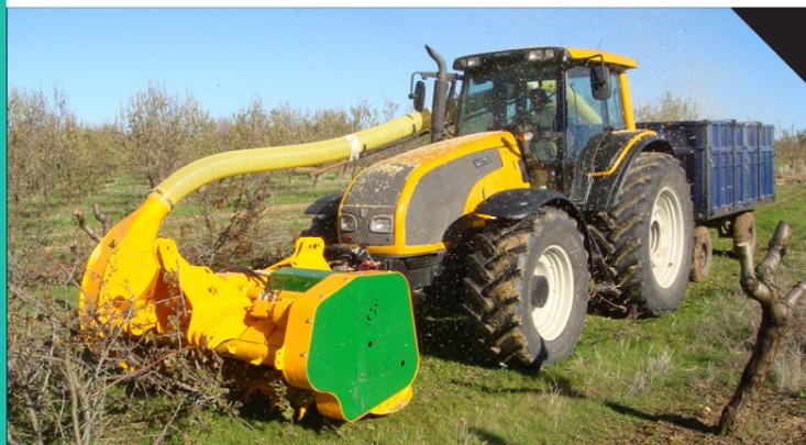
Máquina trituradora recuperadora de madera de poda de olivo, frutos secos y restos forestales, etc. Para acoplar a tractores de 150 - 250 CV o instalar en el tripuntal delantero de un tractor estandar de 200 - 250 CV. En el caso del tractor estandar, éste podrá llevar enganchado un remolque en la parte posterior para recepcionar el material que es conducido por un tubo flexible. Trituradora con doble alimentador
