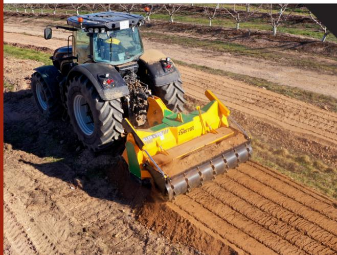
Máquina de preparación de suelo hasta una profundidad de 400 mm, para tractores con Creeper o Vario entre 300 - 500 CV. Transforma terreno forestal, con tocones y rocas, en terreno para cultivo evitando accidentes en posteriores procesos.
