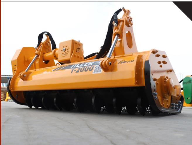
Máquina de preparación de suelo hasta una profundidad de 150 mm, para tractores con Creeper o Vario entre 60 - 80 CV. Transforma terreno forestal, con tocones y rocas, en terreno para cultivo evitando accidentes en posteriores procesos.
