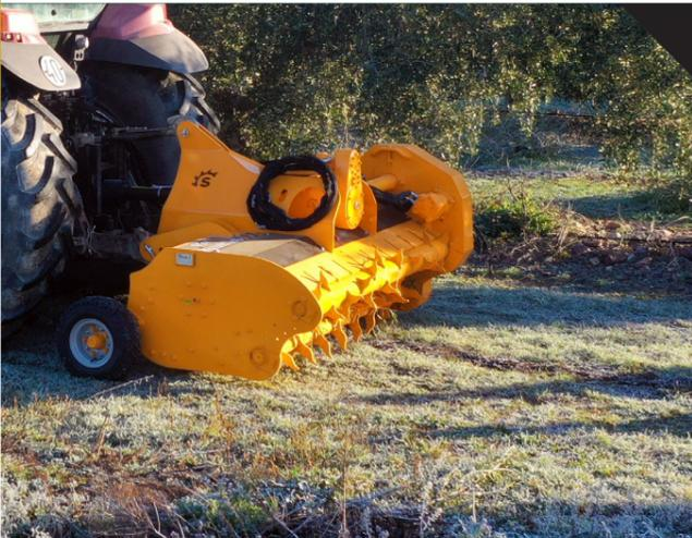
Trituradora con doble alimentador hidráulico ideal para restos de olivo, cítricos y frutos secos de hasta 80 mm de diámetro, con el rotor SPLINTER de SERRAT para tractores de entre 70 y 140 CV.
