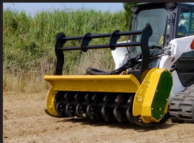
Trituradora para acoplar a minicargadoras de entre 3 y 9 TM de ruedas o cadenas, utilizándose en trabajos de desbroce y mantenimientos forestales, jardinería industrial, etc., combinando la maniobrabilidad de una cargadora rígida y las prestaciones de una trituradora.
