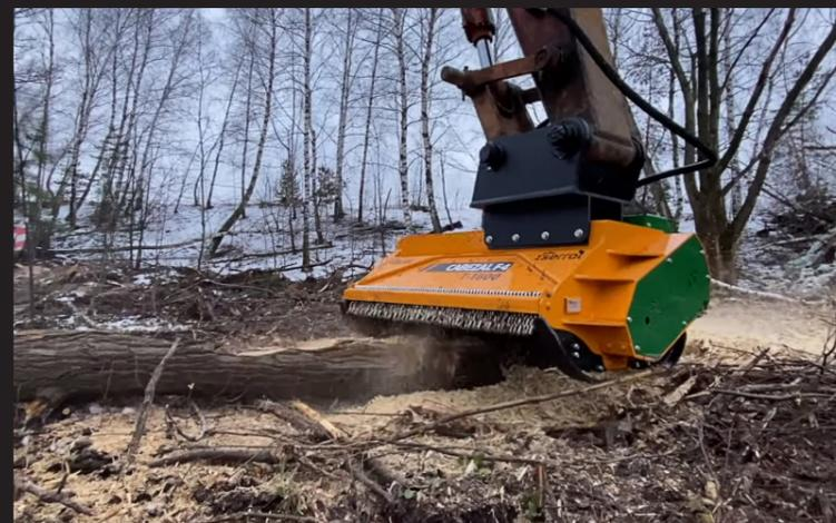
Cabezal adaptable a excavadoras entre 15 - 25 TM.
