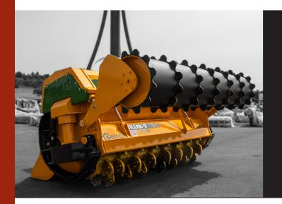
Máquina de preparación de suelo hasta una profundidad de 700 mm, para tractores con Creeper o Vario entre 400 y 700 CV. Transforma terreno forestal, con tocones y rocas, en terreno para cultivo evitando accidentes en posteriores procesos.
