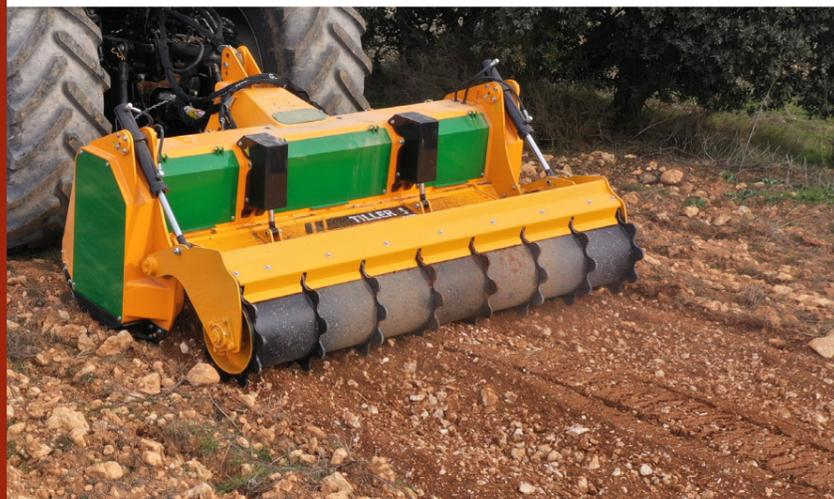
Máquina de preparación de suelo hasta una profundidad de 200 mm, para tractores con Creeper o Vario entre 150 - 200 CV. Transforma terreno forestal, con tocones y rocas, en terreno para cultivo evitando accidentes en posteriores procesos.
