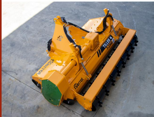
Máquina de preparación de suelo hasta una profundidad de 180 mm, para tractores con Creeper o Vario entre 100 - 130 CV. Transforma terreno forestal, con tocones y rocas, en terreno para cultivo evitando accidentes en posteriores procesos.
