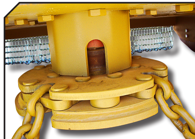
Rotor Serrat con cadenas intercambiables
