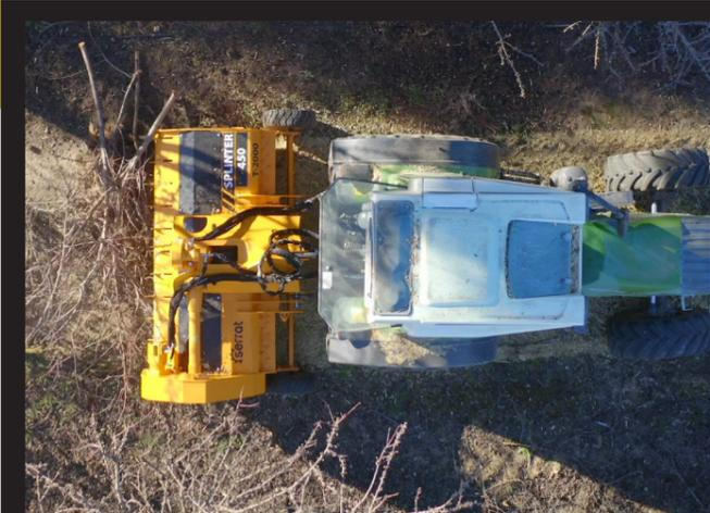
Trituradora con doble alimentador hidráulico ideal para restos de olivo, cítricos y frutos secos de hasta 60 mm de diámetro, con el rotor SPLINTER de SERRAT para tractores de entre 60 y 120 CV.
