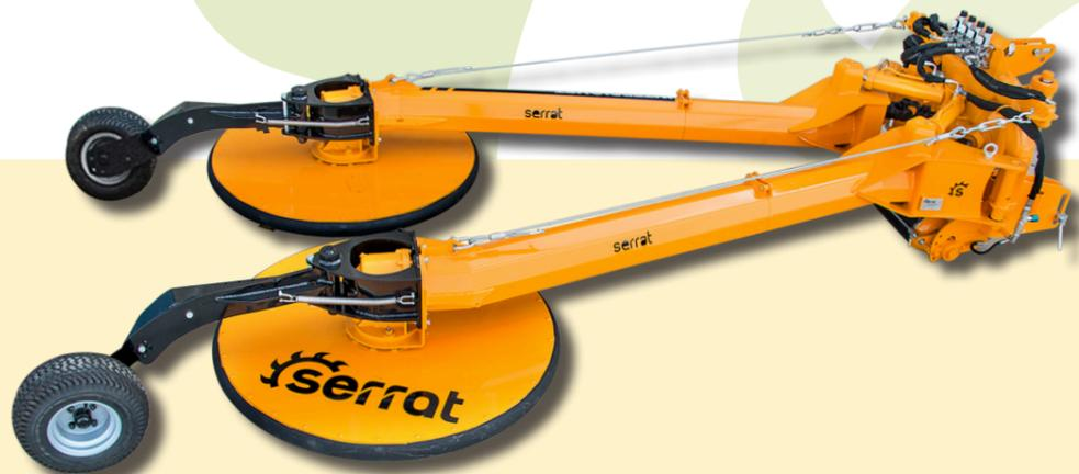
Control hidroneumático de empuje (regulable)
