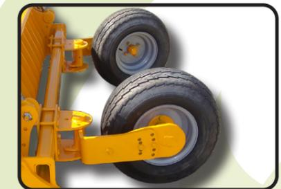
▶ Ruedas traseras orientables y ajustables en altura y anchura
