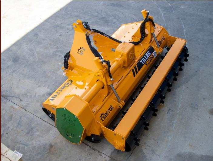
Máquina de preparación de suelo hasta una profundidad de 180 mm, para tractores entre 100 - 150 CV.
