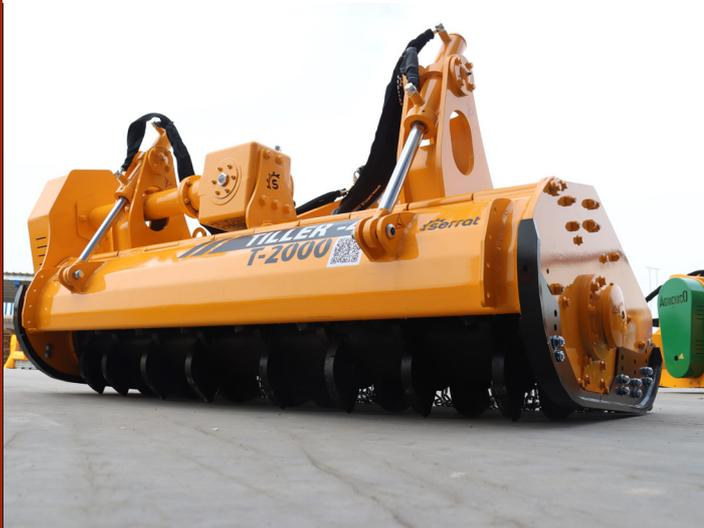
Máquina de preparación de suelo hasta una profundidad de 120-150 mm, para tractores con Vario entre 80 - 120 CV. Transforma terreno forestal, con tocones y rocas, en terreno para cultivo evitando accidentes en posteriores procesos.
