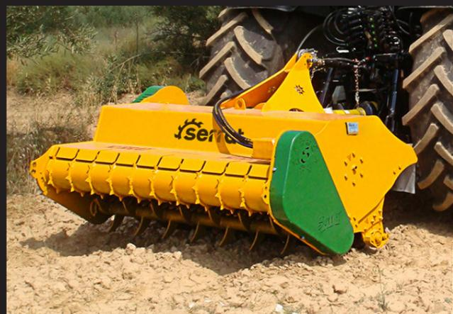
Trituradora con alimentador hidráulico reversible, ideal para castaños, olivos, almendros, cítricos, etc. Máquina con criba trasera para delimitar la granulometría del picado. Equipa rotor POLSER con sistema GIROSTOP, capaz de triturar restos de poda hasta 10 - 12 cm.
