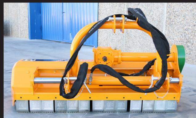
Trituradora diseñada para tractores desde 20 CV a 60 CV de potencia para la agricultura de mantenimiento del manto vegetal y ramas de hasta 3 cm de diámetro.
