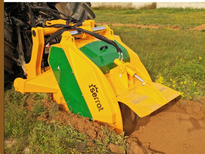
Máquina de preparación de suelo hasta una profundidad de 40 cm, para tractores entre 180 - 250 CV. Transforma los tocones de antiguas plantaciones, dejando un terreno mullido para la próxima plantación.
