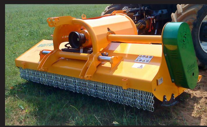
Se utiliza para triturar ramas de poda, restos de cultivo de verano, pastizales, parques y jardines. Es una trituradora de uso Universal y de altísima fiabilidad. Rotor POLSER de 550 mm. de diámetro para madera hasta 10-12 cm. de diámetro. Su configuración reversible y desplazable permite proteger al tractor al no tener que pisar el material a triturar y ajustar el campo de trabajo lateralmente mediante cilindro hidráulico.
