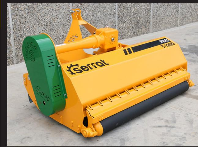
Se utiliza para triturar ramas de poda, restos de cultivo de verano, pastizales, parques y jardines. Es una trituradora de uso Universal y de altísima fiabilidad. Rotor POLSER de 550 mm. de diámetro para madera hasta 10-12 cm. de diámetro. Su configuración fija permite posicionar el grupo para alinear el trabajo al eje del tractor.
