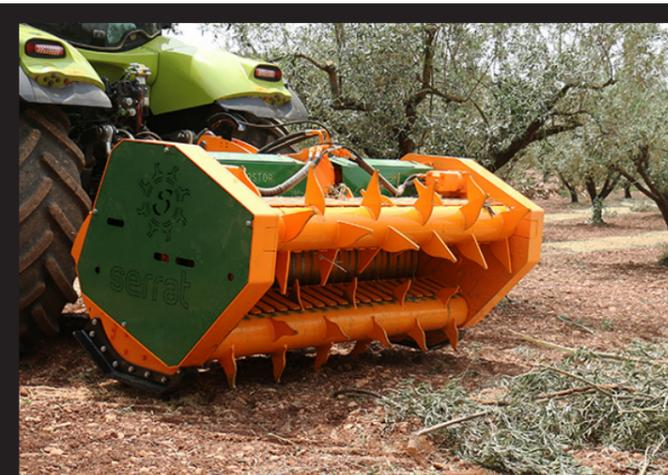
Trituradora con alimentador hidráulico reversible para tractores entre 220 - 350 CV, ideal para la eliminación de grandes cantidades de madera con Ø de hasta 250mm. Máquina para trabajos exigentes, con necesidad de depositar restos muy finos en el terreno, evitando posible plagas y ayudando a su eliminación, para procesos posteriores. Equipa rotor de cuchillas RHENDUEL.
