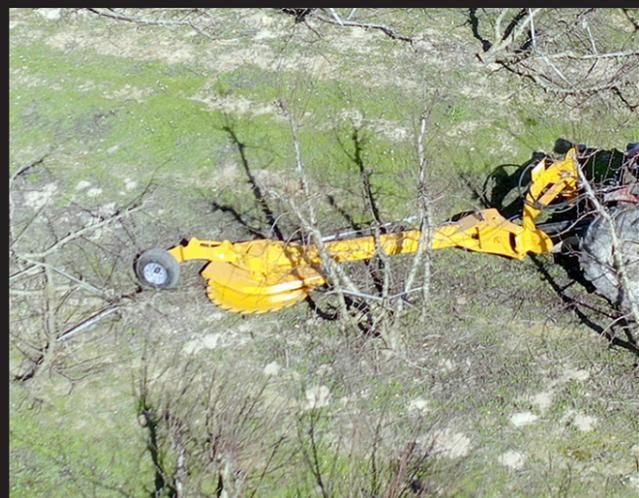
Disco-satélite de eje vertical y accionamiento mecánico para cortar troncos de árboles frutales de 150-200 mm de diámetro.
