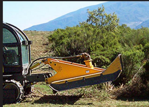
Desbrozadora forestal de cadenas con chasis monocasco en espesor de 15 mm. Grupo hasta 160 CV. Apta para desbroces forestales, creación de pastizales, monte bajo y líneas eléctricas, con matorral en pie hasta 8 cm. Torreta solidaria al chasis. Refuerzos superiores y placas antidesgaste inferiores, para evitar el choque de las cadenas contra el chasis en 15 mm. Plato con sistema de anclaje de cadenas con bulones.
