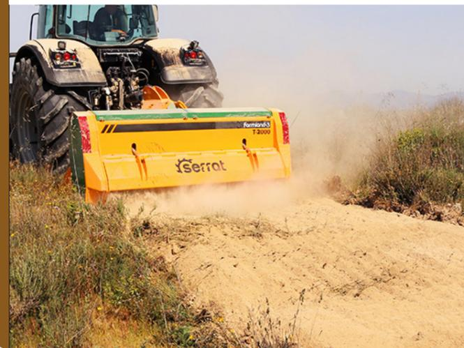
Máquina de preparación de suelo hasta una profundidad de 30 cm, para tractores entre 130 - 150 CV. Transforma terreno forestal, con tocones y rocas, en terreno para cultivo evitando accidentes en posteriores procesos.
