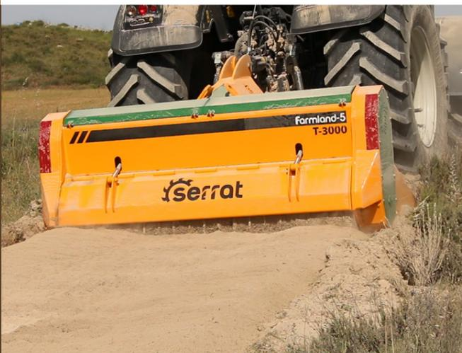
Máquina de preparación de suelo hasta una profundidad de 50 cm, para tractores entre 250 - 500 CV. Transforma terreno forestal, con tocones y rocas, en terreno para cultivo evitando accidentes en posteriores procesos.
