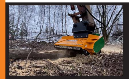
Cabezal adaptable a excavadoras entre 15 - 30 TM.
