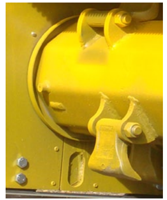
Obturaciones anti-lambres en rotor
